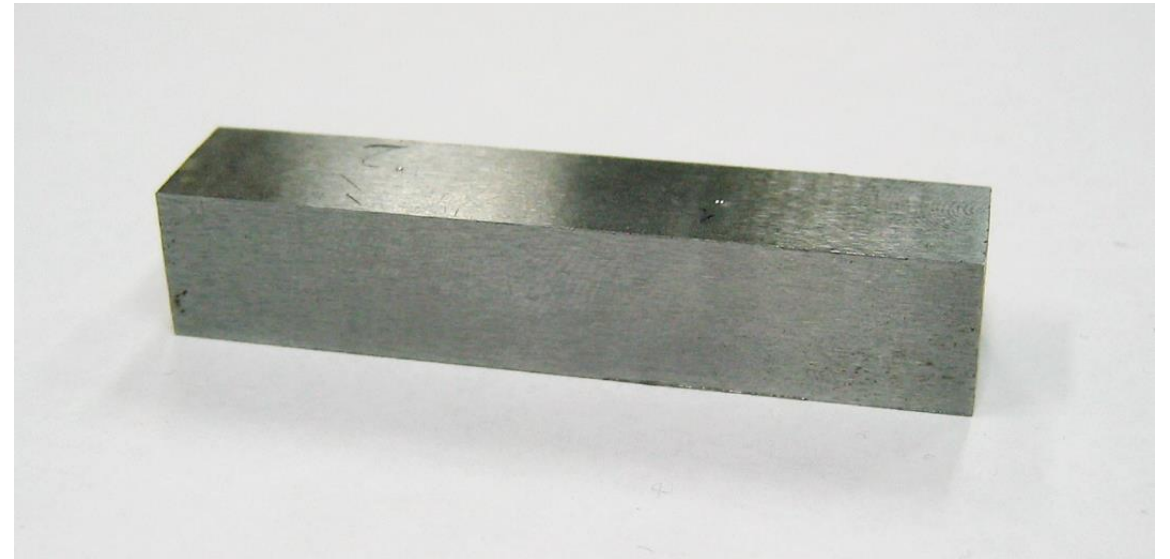
Uzorak od čelika C15E – prosečna veličina zrna 0,019 mm
